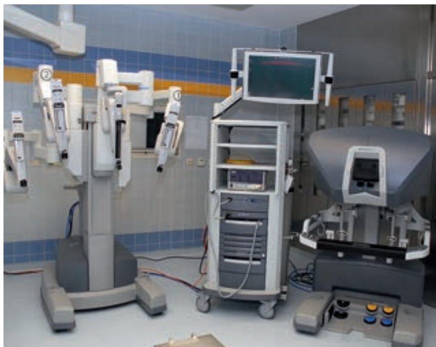
Vierarmiger Telemanipulator, Videoturm mit HD-Bildschirm und Operationskonsole (da Vinci Si HD Surgical System)
