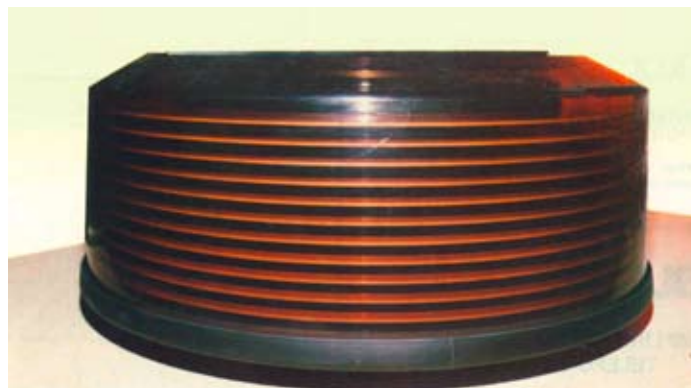
Speicherplatte aus dem Rechenzentrum (1988) – darauf konnten 300 Millionen Zeichen gespeichert werden
