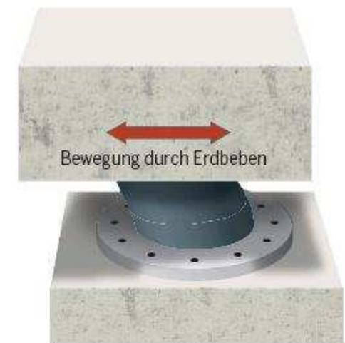
Bei einem Erdbeben bewegt sich der Boden, der Erdbebedämpfer verformt sich, das Gebäude darüber schwankt leicht hin und her, ohne Schaden zu nehmen.
